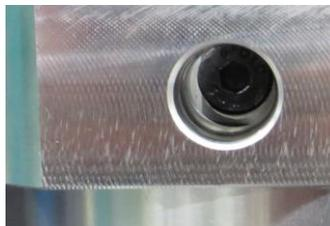
Spannschraube in Klemmnabe mit passendem  $M_A$  anziehen, Verschlussstopfen aufstecken.
