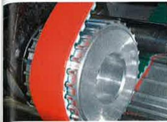
Ein technisches Highlight der Habasync-Zahnriemen ist laut Habasit die mechanische Endverbindung Hinge Joint. Sie ermöglicht einen schnellen und unkomplizierten Zahnriemenwechsel und reduziert dadurch Stillstandszeiten. Die stabile
