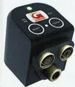
Mit der Schwingungsanalyse Smart-Check mit integrierter Software steht laut MS-Graessner ein Instrument zur Verfügung, das präzise Aussagen über die Getriebelebensdauer ermöglicht. Beschleunigung, Geschwindigkeit und Weg durch Integration sowie Prozessparameter wie Drehzahl und Last sollen exakt analysiert werden. Der Frequenzbereich der Messung liege zwischen 0,8 Hz und
