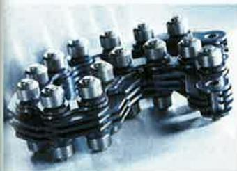
Die Traglaschenketten von Iwis können im Gegensatz zu Stauförderketten in Förderanlagen Steigungen überwinden und durch ihre großen Auflageflächen größere Lasten stabil transportieren. Sie sind kompatibel zu allen Führungen und
